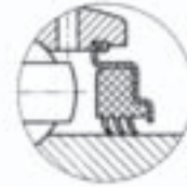
Junta de labio triple (sufijo R3) Triple-lip seal (-suffix-R3) Joint à triple lèvre (suffixe R3) Dreifache Lippendichtung (Suffix R3)
